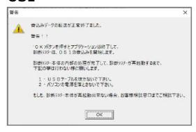
OS1 は診断テスター上で書込みが実行されます。 WRITE3 でデータの転送が完了すると警告メッセ ージが表示されます。
